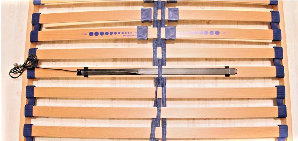
Bild 2: Der Sensor wird unkompliziert mit Klettbandern montiert.
